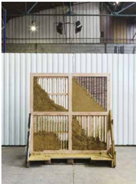
EDGAR SARIN, PROTOTYPE – CONSTRUCTION MODULAIRE BOIS ET TORCHIS – PRODUCTION LE VOYAGE À NANTES © PHILIPPE PIRON / LVAN
